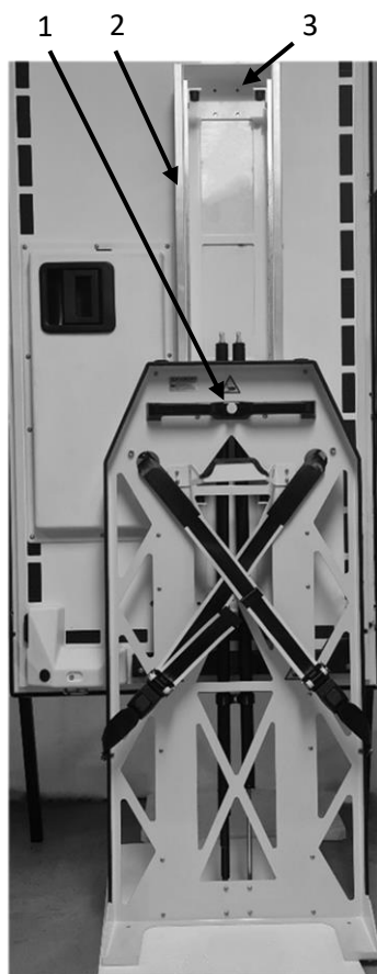
Slika 5: namestitev pločevine na hrbtni strani
