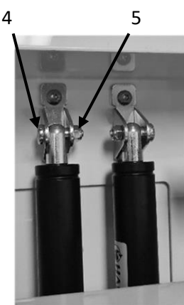
Slika 9: priključni element valjev
