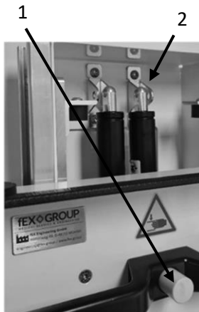
Slika 7: položaj valjev montažo
