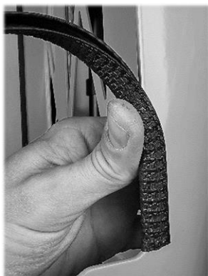
Abbildung 12: Austausch des Kantenschutzes
